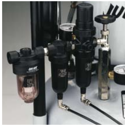
安装在空压机上的过滤器
